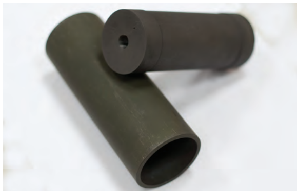
Obr. 3: Pevný bod In určený pro kalibraci bezkontaktních teploměrů
