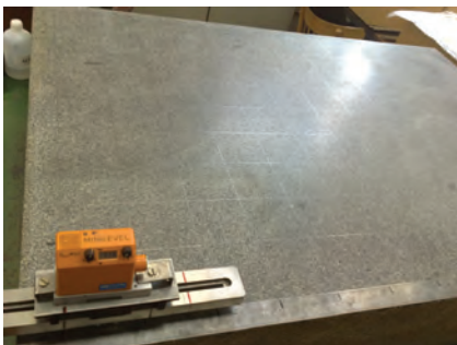
Obr. 8: Orýsovaná granitová příměrná deska s měřicí libelou
