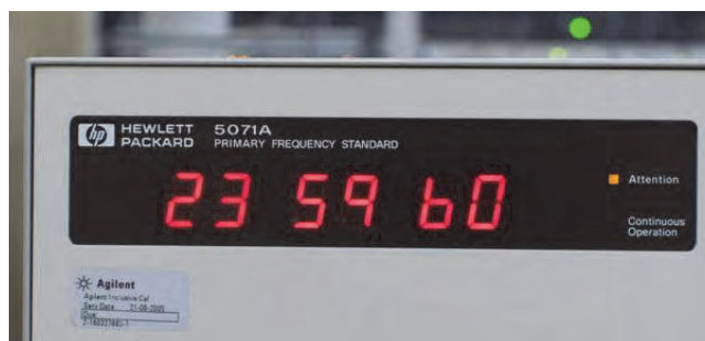
Obr. 1: Neobvyklý časový údaj na atomových hodinách při vložení přestupné sekundy.
