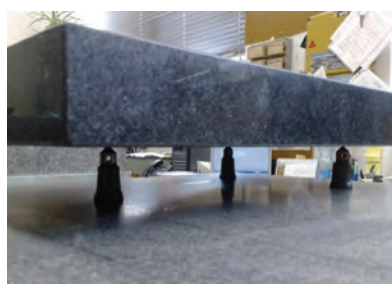
Obr. 2: Ustavení příměrné desky na univerzálních podpěrkách s hrotem
