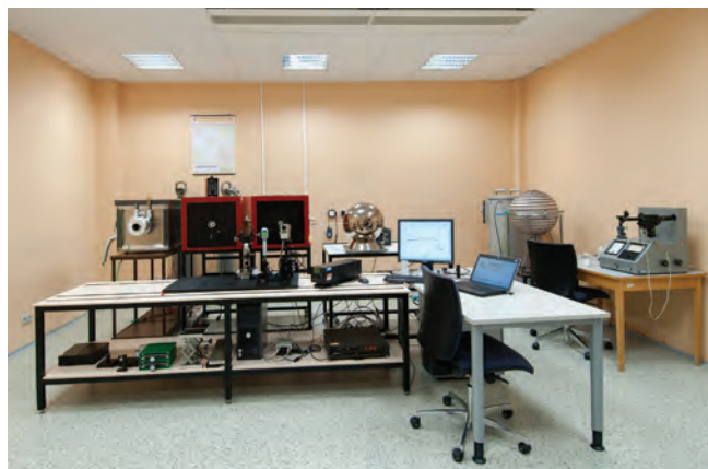
Obr. 2: Sestava státního etalonu teploty pro bezkontaktní měření
