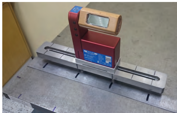
Obr. 7: Orýsovaná litinová příměrná deska s měřicí libelou
